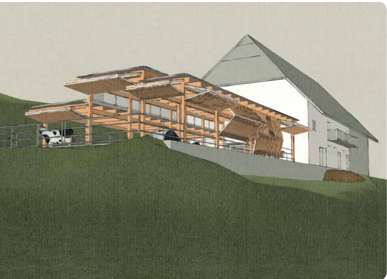
Teil des Projekts Allmende 2.0. sind auch Beispiele von Stallumbauten im Bestand, um kleineren Betrieben den Wechsel von der Anbindehaltung in einen Laufstall aufzeigen zu können.
